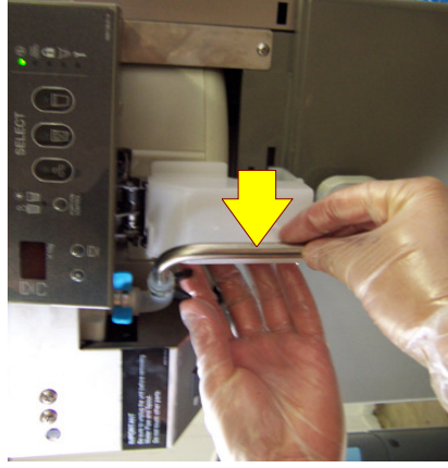
5. Vandrøret frigøres fra isudmundingspanelet med et let ryk og afmonteres via clips for enden af røret.
